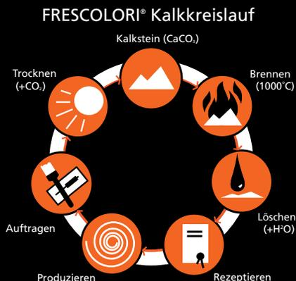
Produkten verarbeitet. Nach dem Auftragen auf einer Wand oder Decke verdunstet das Wasser aus dem Kalk und nimmt stattdessen CO<sub>2</sub> aus der Umgebungsluft auf.
