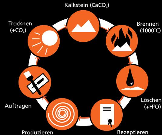
Der Hauptbestandteil unseres FRESCOLORI®-Kalkmarmorputzes – das abgebaute Kalkgestein – durchläuft einen Verarbeitungsprozess, bei dem während des Brennens im Kalkofen Branntkalk (Kalziumoxid) entsteht. Beim nachfolgenden „Löschen“ wird der Branntkalk in Wassergruben eingesumpft: So entsteht der „gelöschte Kalk“ (Kalziumhydroxid).
